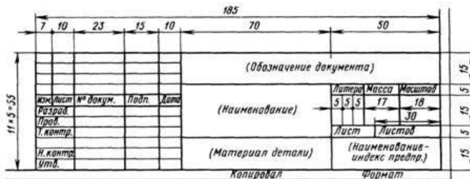
Рис. 2. Основная надпись для технических чертежей
